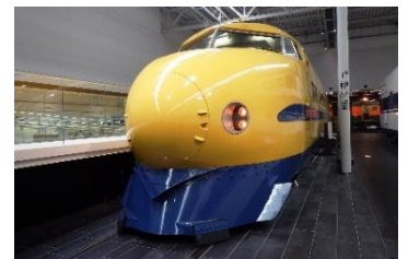
922形新幹線電気軌道総合試験車 (T3編成：ドクターイエロー)
