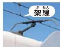
ブレーキをかけた時にできたエネルギーを、架線を通して、他の列車で再利用しています。
